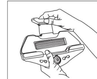
3. Introduzca la tableta en la base del soporte para reposacabezas, y coloque entonces la parte superior de la horquilla sobre la tableta.
