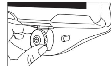
7. Per conservare il supporto, posizionare la parte superiore della piattaforma dietro il supporto principale, quindi spingere la manopola Boa® e ruotare in senso orario fino a stringere il cavo.
