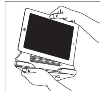
4. Medtem ko držite tablico, vrtljivi gumb Boa® potisnite navzdol, dokler ne zaslišite klika, nato pa ga zvrtite v desno, da pričvrstite kabel. Gumb vrtite tako dolgo, da se bo vrh podstavka tesno prilegal tablici.
