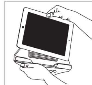
4. Držeći tablet, pritisnite Boa® kotačić prema unutra sve dok ne začujete škljocaj, a zatim ga okrenite u smjeru kazaljki na satu da biste zategnuli kabel. Okrećite tako dugo dok se gornji okvir držača ne spusti dovoljno da učvrsti tablet.
