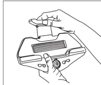
3. A táblagépet helyezze a fejtámlára rögzített tartóba és a tartó felső részét tolja le a táblagépre.
