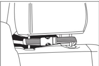
6. Este recomandat să inei tableta când o îndepărtați pentru a nu cădea. Pentru a îndepărta tableta, trageți de butonul Boa® pentru a elibera tensiunea cablului și apoi îndepărtați partea de sus a cadrului de tabletă. Îndepărtați tableta.
