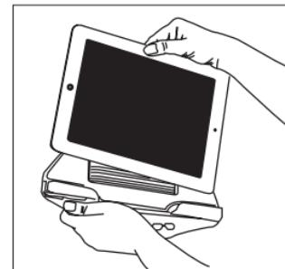
4. Fogja meg a táblagépet, kattanásig nyomja le a Boa® gombot, majd jobbra forgatva feszítse meg a kábelt. Addig forgassa, amíg a tartó felső része pontosan a táblagép tetejére illeszkedik.
