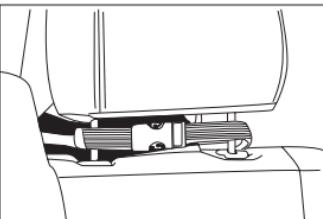
6. Bitte halten Sie das Tablet fest, wenn Sie es abnehmen, um sicherzustellen, dass es nicht auf den Boden fällt. Zum Entfernen des Tablets ziehen Sie den Boa® Knopf heraus, um die Drahtspannung zu lösen, und ziehen Sie dann den Bügel an der Oberseite weg vom Tablet. Nehmen Sie das Tablet ab.
