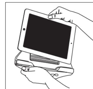
4. Während Sie das Tablet halten, drücken Sie den Boa® Knopf, bis Sie ein Klickgeräusch hören, und drehen Sie dann im Uhrzeigersinn, um den Draht zu spannen. Drehen Sie weiter, bis der Bügel an der Oberseite genau über das Tablet passt.
