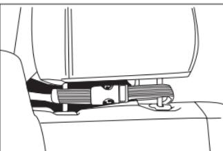
6. Během následujícího postupu odstraňování tablet držete, aby nespadol. Pro odstranění tabletu vytáhněte knoflík Boa® směrem ven a uvolněte úchyt kabelu. Poté vytáhněte horní část kolébky směrem od tabletu. Tablet odstraňte.
