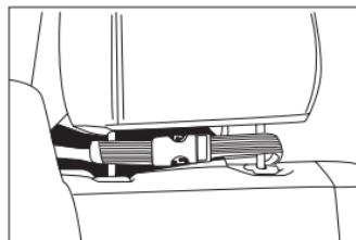
6. A táblagép levétele során fogja meg a táblagépet, hogy ne eshessen le. A táblagép levételéhez a Boa® gombot kihúza lazítsa meg a kábelt, majd a tartó felső részét húzza le a táblagépről. Távolítsa el a táblagépet.
