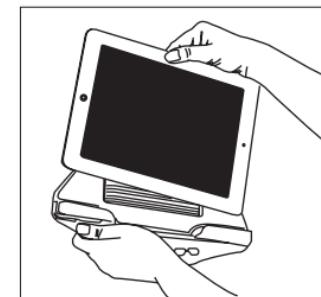
4. Przytrzymując tablet, naciskać w dół gąbkę zamknięcia Boa® do momentu usłyszenia kliknięcia, a następnie obrócić w kierunku ruchu wskazówek zegara, aby napiąć linkę. Obracać dalej, aż góra część kołyski oprze się pewnie na tablecie.
