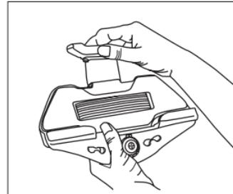
3. Introduceți tableta în baza monturii tetierei, apoi plasați partea de sus a cadrului peste tabletă.
