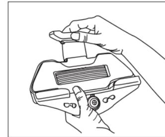
3. Plaats de tablet in de basis van de hoofdsteunbevestiging en plaats de bovenkant van de mand over de tablet.
