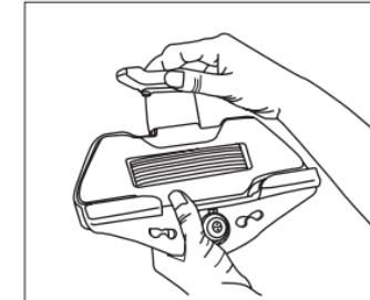
3. Schieben Sie das Tablet in die Kopfstützenhalterung und platzieren Sie den Bügel an der Oberseite über das Tablet.
