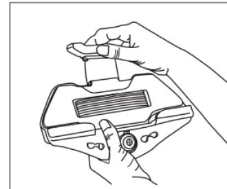
3. Insérez la tablette dans la base de fixation de l'appuie-tête, puis placez le haut de la station d'accueil au-dessus de la tablette.
