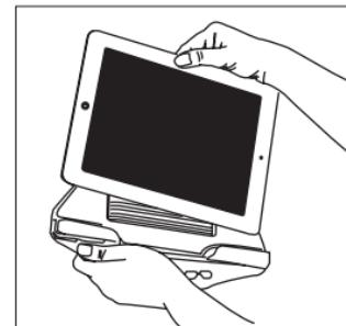
4. Mens du holder din tablet, trykkes ® knappen ned, indtil du hører et klik, og derefter drejes med uret for at stramme. Drej indtil holderens top passer til din tablet.
