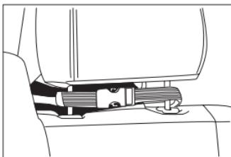
6. Lūdzu, pieturiet planšetdatoru noņemšanas procesa laikā, lai tas nenokristu. Lai noņemtu planšetdatoru, izvelciet Boa® rokturi, lai atslēdzas kabeļa spriegums un tad noņemiet paliktņa augšdaļu no planšetdatora. Noņemiet planšetdatoru.
