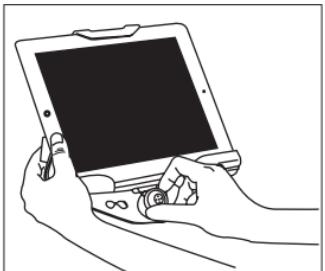
5. Encaixe o suporte no apoio de cabeça utilizando a correia disponibilizada. Puxe e ajuste a fivelha até esta apertar bem o apoio de cabeça.
