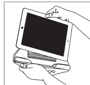
4. Turot planšetdatoru, bīdiet Boa® rokturi uz leju līdz sadzirdēsiet klikšķi, tad pagrieziet pulksteņrādītāja kustības virzienā, lai nosriegotu kabeli. Grieziet līdz paliktņa augšdaļa cieši piegulēs planšetdatoram.
