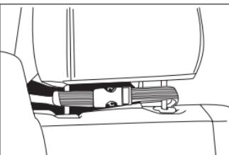
6. Pidä tablet laitteesta kiinni irrottamisen aikana ettei se putoa. Irrota tablet vetämällä Boa®-nuppia kaapelin jännitteen vapauttamiseksi ja nostaa telineen yläosa irti tablet laitteesta. Poista tablet telineestä.
