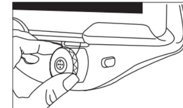
7. Zum Aufbewahren des Halters schieben Sie den Bügel an der Oberseite zurück auf die Haupthalterung, drücken Sie auf den Boa® Knopf und drehen Sie im Uhrzeigersinn, bis der Draht gespannt ist.
