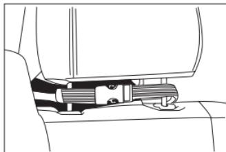
6. Houd de tablet vast wanneer U alles losmaakt om te vermijden dat deze valt. Om de tablet te verwijderen trekt U de Boa® -knop uit om de riem te ontspannen en trekt U vervolgens de bovenkant van de mand weg van de tablet. Verwijder de tablet.
