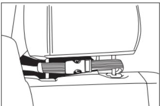
6. Пожалуйста, придерживайте планшетное устройство, когда будете снимать его, чтобы оно не упало. Чтобы снять планшетное устройство, потяните ручку Boa® наружу, чтобы ослабить натяжение шнуря, и сдвиньте верхнюю часть гнезда с устройства. Выньте устройство.
