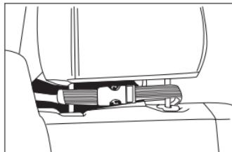
6. Hoidke tahvelarvutit järgneva eemaldamisprotsessi ajal, et see maha ei kukiks. Tahvelarvuti eemaldamiseks tömmake Boa®-nupp kaabli pingi vabastamiseks välja ning seejärel tömmake hoidiku ülaosa tahvelarvutist eemale. Eemaldage tahvelarvuti.
