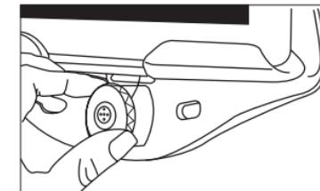
7. Pro uskladnění držáku vložte horní část kolébky do hlavního držáku, stiskněte knoflík Boa® a otočte doprava dokud se kabel neutáhne.
