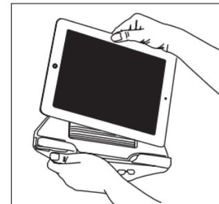
4. Podržte tablet a stiskněte knoflík Boa® směrem dolů, dokud neuslyšíte cvaknutí. Otočte doprava a kabel utáhněte. Otáčejte, dokud horní část kolébky nedosedne na tablet.
