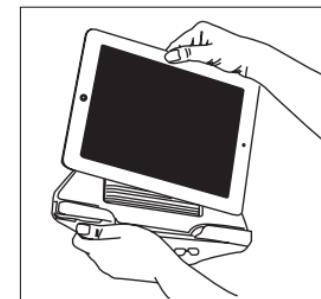
4. Terwijl U de tablet vasthoudt drukt U de Boa®knop in tot U een klik hoort. Draai deze vervolgens rechtsom om de riem aan te passen. Blijf draaien tot de bovenkant van de mand goed tegen de tablet komt te zitten.
