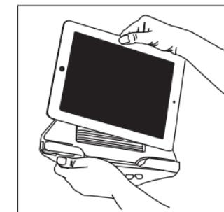
4. Mientras sujetá la tableta, pulse el botón Boa® hacia abajo hasta que escuche un click, y gírello entonces en el sentido de las agujas del reloj para tensar el cable. Continúe girándolo hasta que la parte superior de la horquilla quede fuertemente ajustada a la tableta.
