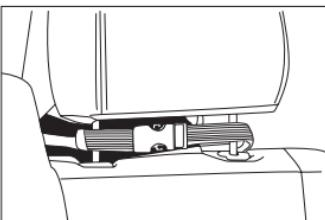
6. Durante o processo de remoção seguinte, segure o tablet para que este não caia. Para remover o tablet, puxe o manípulo Boa® para fora para aliviar a tensão do cabo e de seguida puxe parte superior do suporte para libertar o tablet. Remova o tablet.
