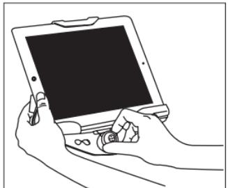
5. Attachez la fixation sur l'appuie-tête de la voiture en utilisant la courroie fournie. Tirez et ajustez la boucle jusqu'à ce que l'unité soit serrée contre l'appuie-tête.
