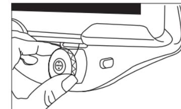
7. Para guardar el soporte, coloque de nuevo la parte superior de la horquilla en el soporte principal, y pulse entonces el botón Boa® hacia dentro y gírello en el sentido de las agujas del reloj hasta que el cable esté ajustado.
