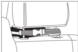
6. Düşmeyeceğinden emin olmak için aşağıdaki sökme işlemi süresince lütfen tableti tutun. Tabletı çıkarmak için, kablo gergisini alacak şekilde Boa® topuzunu çekin ve kızağın üst kısmını tabletten uzaklaştırın. Tabletı çıkarın.
