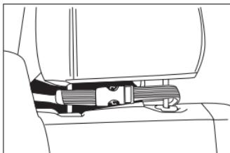
6. Vänligen håll I tabletten under följande process då du tar bort tabletten. Tryck in Boa® hantaget uppåt för att släppa upp kabelspänningen och tryck därefter upp toppen på ställningen, bort från tabletten. Ta bort tabletten.
