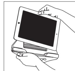
4. Удерживая планшетное устройство, вставьте ручку Boa® обратно до щелка и поверните её по часовой стрелке, чтобы затянуть шнур. Затягивайте до тех пор, пока верхняя часть гнезда не будет плотно прилегать к планшетному устройству.
