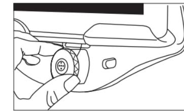
7. För att förvara ställningen, placera toppen av ställningen bakåt på hållaren, tryck därefter Boa® hantaget inåt och vrid medurs tills dess att kabeln har spännts fast.
