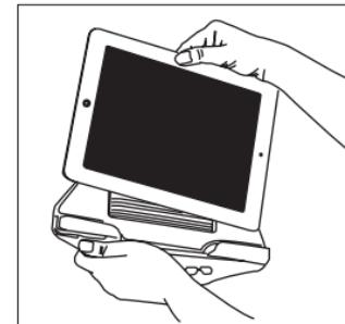
4. En maintenant la tablette, poussez le bouton Boa® jusqu'à entendre un déclic, puis tournez-le dans le sens des aiguilles d'une montre pour resserrer le câble. Continuez à tourner jusqu'à ce que le haut de la station d'accueil s'adapte parfaitement contre la tablette.
