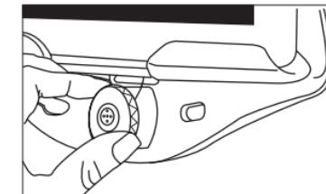
7. Размещая держатель на хранение, поместите верхнюю часть гнезда обратно на сам держатель, вставьте ручку Boa® и поверните её по часовой стрелке до положения, в котором шнур будет затянут.
