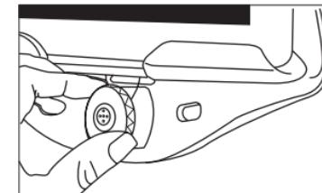
7. W celu przechowania uchwytu, włożyć górną część kołyski z powrotem do głównego uchwytu, a następnie wcisnąć gąbkę zamknięcia Boa® i przekrącić w kierunku ruchu wskazówek zegara aż do napięcia linki.
