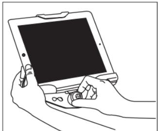
5. Fije el soporte al reposacabezas del coche mediante la correa suministrada. Tire de y ajuste la hebilla hasta que la unidad quede fuertemente fijada al reposacabezas.
