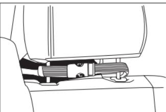
6. Przy następnym zdejmowaniu tabletu, proszę go przytrzymać, aby nie upadł. Aby wyjąć tablet, należy pociągnąć gąbkę zamknięcia Boa® na zewnątrz w celu zwolnienia napięcia linki, a następnie odciągnąć górną część kołyski od tabletu. Wyjąć tablet.
