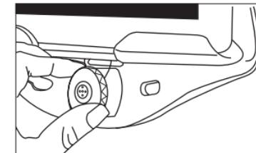
7. Da bi spravili nosilec, vrh podstavka postavite nazaj na glavni nosilec, vrtljivi gumb Boa® pa potisnite in zvrtite v desno, dokler kabel ni privit.
