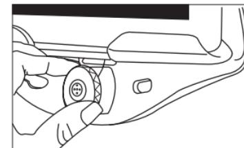
7. Za pospremanje nosača za tablete, stavite gornji okvir natrag u držač, pritisnite Boa® kotačić prema unutra i zatim ga okrećite u smjeru kazaljki na satu sve dok ne zategnete kabel.
