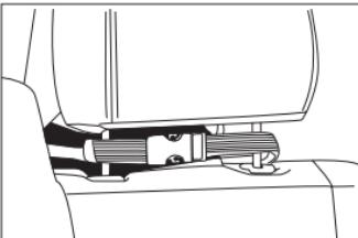
6. Sujete por favor la tableta durante el siguiente proceso de extracción para asegurar que no se caiga. Para extraer la tableta, tire del botón Boa® hacia fuera para liberar la tensión del cable y tire entonces de la parte superior de la horquilla separándola de la tableta. Extraiga la tableta.
