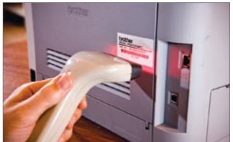
Anslut en streckkodsavläsare till skrivarens serieport och skriv ut etiketter direkt från TD-4000/TD-4100N*.
