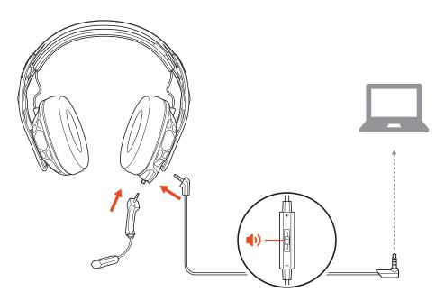
Connect to console RIG 500 PRO ESPORTS, RIG 500 PRO HC, RIG 500 PRO HX/HX SE
